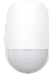
Der DS-PDP15P-EG2-WE(B) ist ein vollständig überwachter Zwei-Wege-Funkmelder mit Bewegungserkennung, Manipulationsschutz, schwacher Batterie und Überwachung. Die zwei eingebauten Batterien ermöglichen eine Laufzeit von bis zu 5 Jahren, überwachen einen Bereich im Umkreis von 15 m und ist tierimmun.
