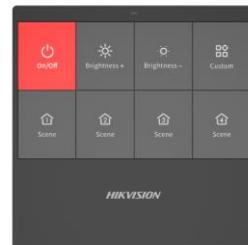
Das LCD-Bedienfeld ist für die nahtlose Integration mit dem Hikvision LCD-Display (Unit) konzipiert. Er eignet sich ideal für Überwachungszentren, Kommandozentralen und Ausstellungsräume und ermöglicht die Steuerung des Stroms, die Einstellung der Helligkeit und das Umschalten zwischen mehreren Szenen mit nur einem Tastendruck - für eine intuitive Bedienung und eine verbesserte Effizienz des visuellen Managements.
