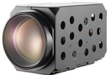
O módulo de câmera de rede com zoom de 4 MP 23 × Hikvision iDS-2ZMN2312S(B) adota um chip CMOS de varredura progressiva de 1/1,8". Com a lente de zoom óptico de 23 ×, o módulo da câmera oferece mais detalhes em áreas amplas. Essa série de módulos de câmera pode ser usada para diferentes tipos de câmeras PTZ e sistemas de posicionamento.
