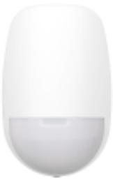
Les détecteurs à double technologie de la série DS-PDD12-EG2 sont équipés de la technologie micro-ondes K-Band 24 GHz et de la technologie de lentille de fresnel 3D. Technologie sans interférence permettant une installation dos à dos et sans pénétration dans le mur. Il permet d'installer et de configurer le détecteur plus rapidement que les DT traditionnels, ce qui permet à l'installateur de gagner du temps et d'économiser de l'argent.
